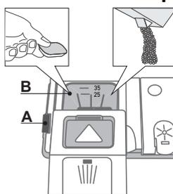
**Щоб відкрити дозатор миючого засобу, використовуйте механізм відкриття А.**
