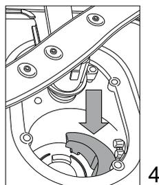
Після очищення фільтрів встановіть вузол фільтра на місце та закріпіть його у цьому положенні належним чином; це дуже важливо для ефективного функціонування посудомийної машини.
