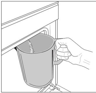
Nachdem die Funktion "Abpumpen" ausgewählt wurde oder dies vom Display angezeigt wird, die Funktion starten und die angegebenen Maßnahmen befolgen: Öffnen Sie die Tür und stellen Sie einen großen Krug (wenigstens 2 Liter Fassungsvermögen) unter die Entleerungsdüse, die sich unten am Bedienfeld, links von der Zulaufdüse befindet. Falls
