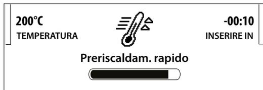
Al termine del preriscaldamento, un segnale acustico indicherà che il forno ha raggiunto la temperatura impostata. A questo punto, infornare la pietanza e iniziare la cottura premendo  $\blacktriangleright$ : il forno selezionerà automaticamente la funzione Statico.
