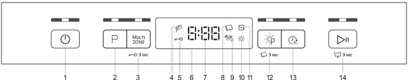
1. Ein-Aus/Reset Taste mit Anzeigelicht
