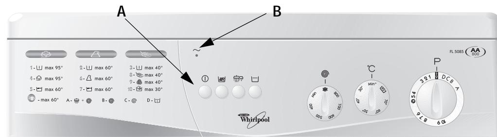
**În timpul programului de spălat selecționat butonul de selectare a programului se mișcă pe etape în sensul acelor de ceasornic prin toate fazele **prespălare, spălare principală, împezire și centrifugare**. Fiecare etapă durează de la câteva secunde până la câteva minute.**
