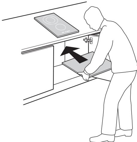
Kochfeld in den Ausschnitt und prüfen Sie, dass das Glas flach und parallel zur Arbeitsplatte ist. Die Befestigungsklammen sind für jede Art von Arbeitsplattenmaterial (Holz, Marmor usw.) ausgelegt.
