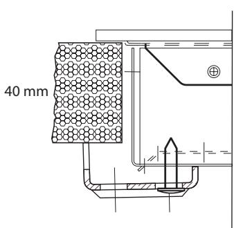
la photographie. Puis poussez la table de cuisson à l'intérieur de la découpe et vérifiez que le verre est plat et parallèle au plan de travail. Les clips de fixation sont conçus pour toute sorte de matériau de plan de travail (bois, marbre, etc).
