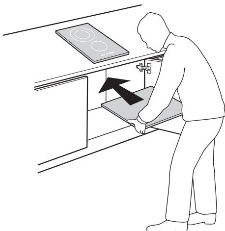
Spingere il piano di cottura nel foro e assicurarsi che il vetro sia orizzontale e parallelo al piano di lavoro. I fermi di fissaggio sono adatti per piani di lavoro di qualsiasi materiale (legno, marmo, ecc.).
