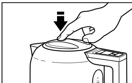
**1** Soulevez le couvercle de la bouilloire en appuyant sur le bouton d'ouverture.
