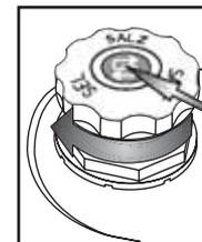
Vissez le bouchon. Éliminez les résidus de sel autour du bouchon. Certains réservoirs à sel ont un indicateur de niveau intégré dans le bouchon (voir la méthode de contrôle ci-dessous).
