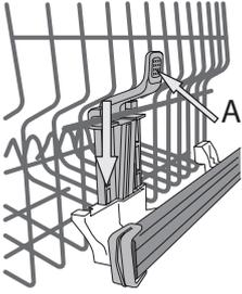
الرف العلوي مزود بضابط ارتفاع الرف العلوي (انظر الشكل)، دون الضغط على الأذرع قم برفعها ببساطة عن طريق مسك جوانب الرف، بمجرد ثبات الرف في وضعه العلوي.
