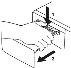
2. Entfernen Sie den Einsatz aus der Weichspülerkammer.
