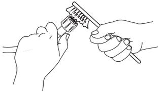
3. Schrauben Sie nun den Zulaufschlauch von der Rückseite der Waschmaschine mit der Hand ab. Ziehen Sie das Filtersieb mit einer Zange aus dem Ventil auf der Rückseite der Waschmaschine heraus und reinigen Sie es vorsichtig.
