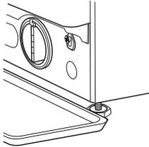
8. Entleeren Sie das Wasser: Drehen Sie den Filter langsam gegen den Uhrzeigersinn, bis das gesamte Wasser herausgeflossen ist. Lassen Sie das Wasser ausfließen, ohne den Filter zu entfernen. Sobald der Behälter voll ist, schließen Sie den Wasserfilter indem Sie ihn im Uhrzeigersinn drehen. Entleeren Sie den Behälter. Wiederholen Sie den Vorgang, bis das gesamte Wasser abgelaufen ist.
