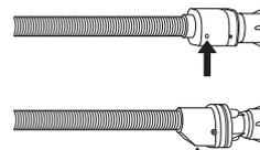
Für Wasserstoppschläuche: Überprüfen Sie das kleine Kontrollfenster des Sicherheitsventils (siehe Pfeil). Wenn es rot ist, wurde die Funktion zum Wasserstopp ausgelöst und der Schlauch muss durch einen neuen ersetzt werden. Drücken Sie während dem Entfernen des Schlauches die Entriegelungstaste (falls vorhanden), um den Schlauch abzuschrauben.
