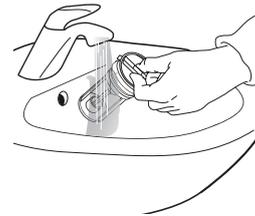
11. Setzen Sie den Wasserfilter ein und installieren Sie erneut den Sockel: Setzen Sie den Wasserfilter wieder ein, indem Sie ihn im Uhrzeigersinn drehen. Stellen Sie sicher ihn soweit wie möglich hineinzudrehen; der Filtergriff muss in vertikaler Position sein. Um die Wasserdichtigkeit des Wasserfilters zu testen, können Sie ungefähr 1 Liter Wasser in das Waschmittelfach füllen. Dann den Sockel erneut installieren.
