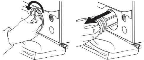
10. Reinigen Sie den Wasserfilter: entfernen Sie die Rückstände im Filter und reinigen Sie ihn unter fließendem Wasser.
