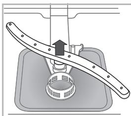
L'irroratore inferiore si smonta facendo pressione sulle linguette poste ai lati e tirandolo verso l'alto.
