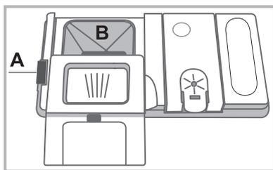
Introdurre il detersivo solo nella vaschetta "B" asciutta. La quantità di detersivo adibita al prelavaggio, deve essere posizionata direttamente in vasca.
