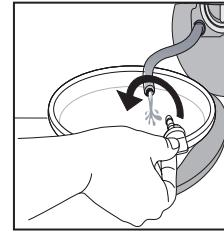
6. Περιστρέψτε τη λαβή του φίλτρου εξαγωγής και τραβήξτε το από το περίβλημα.
