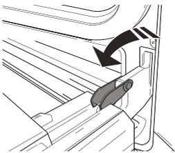
**2.** Die Tür so weit wie möglich schließen. Die Tür mit beiden Hände festhalten – diese nicht am Griff festhalten. Die Tür einfach entfernen, indem sie weiter geschlossen und gleichzeitig nach oben (a) gezogen wird, bis sie sich aus ihrem Sitz löst (b).
