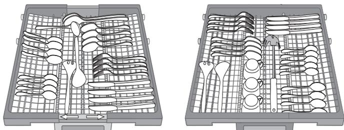
Il terzo cestello è stato progettato per alloggiare le posate durante il lavaggio. La possibilità di sistemare le posate a parte ne rende più semplice la raccolta dopo il lavaggio e migliora le prestazioni sia nella fase di lavaggio che in quella di asciugatura.
