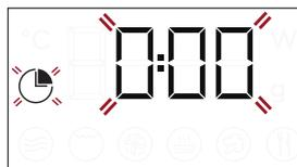
Appuyez sur **OK** pour lancer la minuteur. Un signal sonore se fait entendre et une indication apparaît à l'écran lorsque la minuteur a terminé le compte à rebours. Pour modifier la minuteur une fois qu'elle est active, tournez le bouton de réglage et appuyez ensuite sur **OK** pour confirmer.
