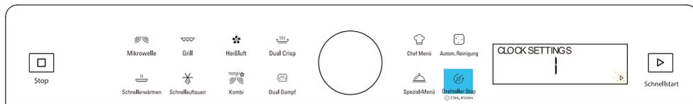
Sie können die Zeit einstellen, wenn Sie die Taste „Drehteller Stop“ 3 Sekunden gedrückt halten oder das Gerät zum ersten Mal (oder nach einem Stromausfall) einschalten. In diesem Fall ruft das Produkt automatisch den Zeiteinstellmodus auf.
