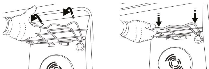
3. Para volver a situar la resistencia en su posición, elevarla, tirar de ella ligeramente hacia fuera y comprobar que queda apoyada en las sujetaciones laterales.
