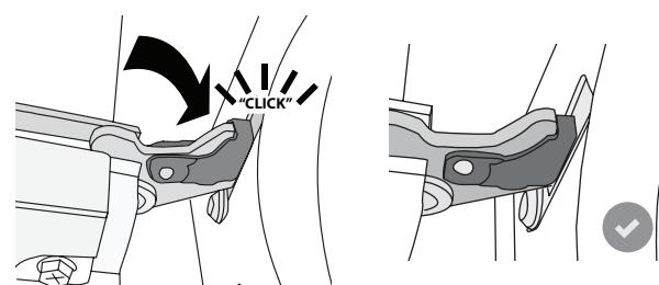
5. Versuchen, die Tür zu schließen und sicherstellen, dass sie auf das Bedienfeld ausgerichtet ist. Ist dies nicht der Fall, die oben aufgeführten Schritte wiederholen: Die Tür könnte beschädigt werden, wenn dies nicht richtig funktioniert.
