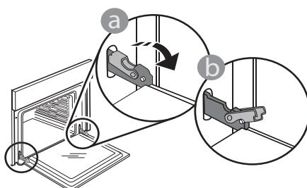
Die Tür einfach entfernen, indem sie weiter geschlossen und gleichzeitig nach oben gezogen wird, bis sie sich aus ihrem Sitz löst. Die Tür seitlich abstellen und auf eine weiche Oberfläche legen.
