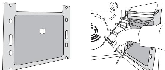
Um die selbstreinigenden Eigenschaften der katalytischen Wände bestmöglich zu nutzen, wird empfohlen, den Ofen für ungefähr eine Stunde auf 200 °C unter Verwendung der „Umluft“-Funktion aufzuheizen. Der Ofen muss während dieser Zeit leer sein.
