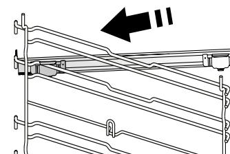
Fixe o encaixe superior da corrediça à guia de nível e faça-a deslizar até parar. Baixe o outro encaixe para o posicionar.
