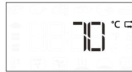
Premere per iniziare l'impostazione dei valori. Ruotare la manopola per impostare la temperatura desiderata per la sonda. Premere per confermare. Ruotare la manopola per impostare la temperatura interna del forno.
