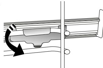
Para fixar a guia, pressione a parte inferior do dispositivo de fixação firmemente contra a guia de nível. Assegure-se de que as corrediças se movem livremente. Repita estes procedimentos para a outra guia de nível, no mesmo nível.
