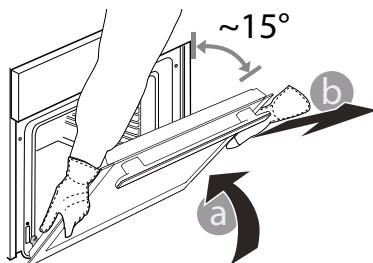
3. Vuelva a instalar la puerta llevándola hacia el horno, alineando los ganchos de las bisagras con sus alojamientos y fijando la parte superior en su alojamiento.
