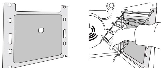
Para fazer o melhor uso possível das propriedades de limpeza automática dos painéis catalíticos, recomendamos que aqueça o forno a 200 °C durante cerca de uma hora, utilizando a função "Cozedura Convecção". O forno deve estar vazio durante o aquecimento. Deixe o aparelho arrefecer antes de remover quaisquer resíduos de alimentos através de uma esponja não abrasiva.
