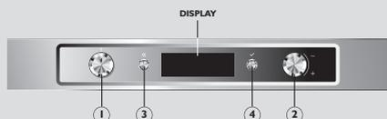
1. **Bouton Fonction** : pour allumer/éteindre le four et sélectionner les différentes fonctions
