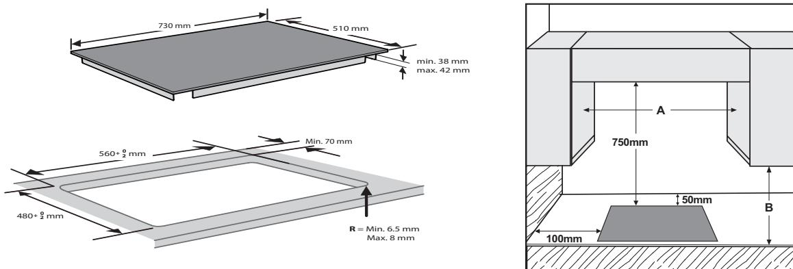
**ПРИМІТКА.** Якщо відстань «A» між настінними шафами має значення в діапазоні від 600 до 730 мм, висота «Б» повинна мати значення принаймні 530 мм. Якщо відстань «A» між настінними шафами більша за ширину варильної поверхні, висота «Б» повинна мати значення принаймні 400 мм. У разі встановлення витяжки над варильною панеллю див. інструкції виробника витяжки, щоб визначити правильну відстань.
