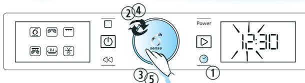
**KADA SE UREĐAJ PO PRVI PUT UKLJUČI U ELEKTRIČNU MREŽU** pitat će vas da postavite sat.
