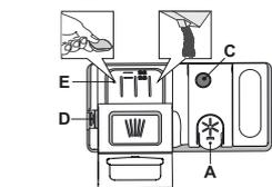
O abrillantador facilita a SECAGEM da loiça. O distribuidor de abrillantador **A** deve ser enchido quando o indicador ótico escuro na tampa do distribuidor **C** se tornar transparente. **NUNCA deite o abrillantador diretamente na cuba da máquina.**
