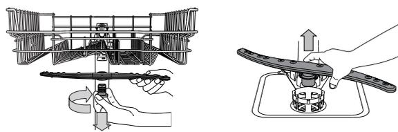
Para retirar o braço aspersor superior, rode o anel de bloqueio de plástico no sentido dos ponteiros do relógio.
