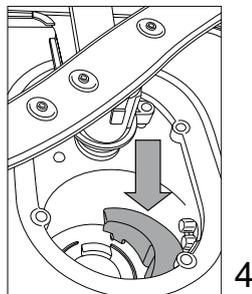
Setzen Sie die Filtereinheit nach der Reinigung der Filtersiebe wieder korrekt in ihren Sitz ein, dies ist äußerst wichtig, um eine ordnungsgemäße Betriebsweise des Geschirrspülers zu gewährleisten.
