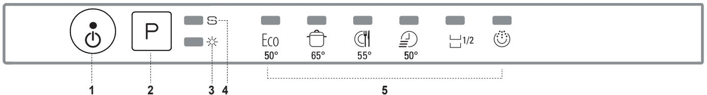
1. Ein-Aus/Reset Taste mit Anzeigelicht
