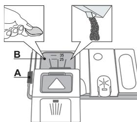
**Zum Öffnen des Spülmittelbehälters den Öffnungsmechanismus **A** drücken. Füllen Sie das Spülmittel ausschließlich in das trockene Fach **B** ein. Die für den Vorspülgang benötigte Spülmittelmenge wird direkt in den Geschirrspüler gegeben.**
