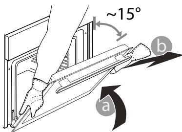
**3. Montera tillbaka luckan** genom att flytta den mot ugnen, ställa in gångjärnens krokar i höjd med fästena och säkra den övre delen på fästet.
