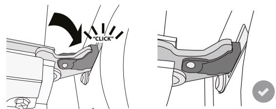
**5. Testa att stänga luckan och kontrollera att den är i linje med kontrollpanelen.** Om den inte är det, upprepa stegen ovan: Dörren kan skadas om den inte fungerar som den ska.
