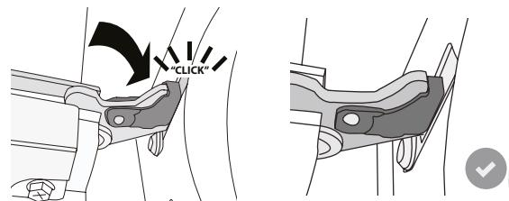
**5. Prøv å lukke døren** og sjekk for å være sikker på at den er på linje med kontrollpanelet. Hvis den ikke gjør det, gjenta trinnene ovenfor: Døren kan bli skadet hvis det ikke fungerer som den skal.
