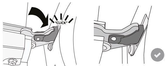
**5. Prøv at lukke lågen, og tjek for at sikre, at den flugter betjeningspanelet.** Hvis det ikke er tilfældet, skal du gentage ovenstående trin: Lågen kan blive beskadiget, hvis den ikke fungerer rigtigt.
