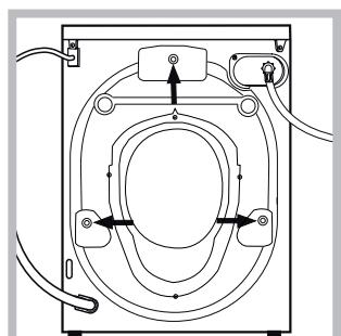
3. Αφαιρέστε τις 3 βίδες προστασίας για τη μεταφορά και το λαστιχάκι με το σχετικό διαχωριστικό, που βρίσκονται στο πίσω μέρος (βλέπε εικόνα).
