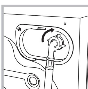
2. Conectați tubul de alimentare la mașina de spălat, înșurubândul la priza de apă respectivă, amplasată în partea posterioară, sus în dreapta (a se vedea figura).
