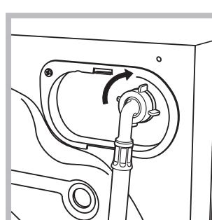
2. Συνδέστε το σωλήνα τροφοδοσίας στο πλυντήριο βιδώνοντάς τον στην αντίστοιχη είσοδο νερού, στο πίσω μέρος επάνω δεξιά (βλέπε εικόνα).
