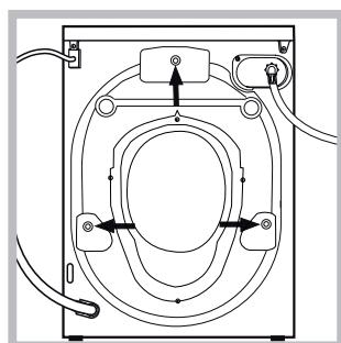
3. Scoateți cele 3 șuruburi de protecție pentru transport și cauciucul cu distanțierul respectiv, situate în partea posterioară (a se vedea figura).
