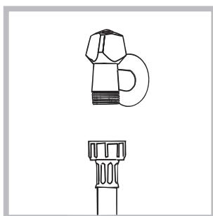
1. Conectați furtunul de alimentare, înșurubându-l la un robinet de apă rece cu gura filetată de 3/4 gaz (a se vedea figura). Înainte de conectare, lăsați apa să curgă până când nu a devenit limpede.
