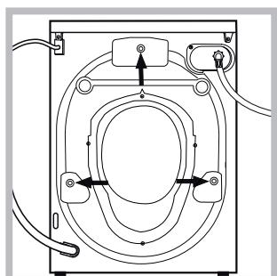
3. Видаліть 3 запобіжні гвинти для транспортування та прокладку з відповідною розпірною деталлю, які знаходяться позаду (див. малюнок).
