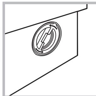
2. odskrutkujte veko otáčaním proti smeru hodinových ručičiek (*vid' obrázok*): vyečenie malého množstva vody je úplne bežným javom;
