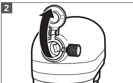
2 Klappen Sie die Abdeckung der Zubehörnabe zum Öffnen nach oben.
