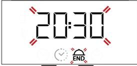
Utilize  $\pm$  ou  $\square$  para definir o tempo de fim da cozedura pretendido e, em seguida, prima  $\odot$  para confirmar. Ative a função rodando o *botão do termóstato* para a temperatura requerida: a função irá permanecer em pausa até ser iniciada automaticamente após o período de tempo calculado para concluir a cozedura à hora programada.
