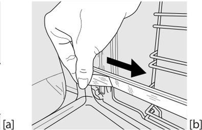
**REMOVING THE SLIDING RUNNERS [c]**
