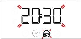
Utilisez  $\pm$  ou  $\bar{\pm}$  pour régler la durée de cuisson et appuyez sur  $\odot$  pour confirmer. Lancez la fonction en tournant le *bouton du thermostat* à la température désirée : la fonction reste en veille et démarre automatiquement après la période d'attente calculée pour que la cuisson se termine à l'heure désirée.
