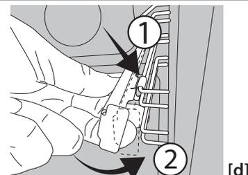
**SMONTAGGIO E RIMONTAGGIO DELLE GRIGLIE LATERALI**
