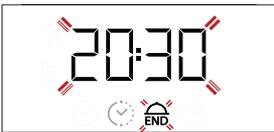
Utilice  $\pm$  o  $\square$  para ajustar el tiempo deseado de finalización de la cocción y pulse  $\odot$  para confirmar.
