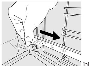
**RIMOZIONE DELLE GUIDE DI SCORRIMENTO [c]**
