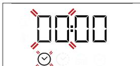
Utilisez ou pour régler l'heure et appuyez sur pour confirmer. Les deux chiffres des minutes clignotent. Utilisez ou pour régler les minutes et appuyez sur pour confirmer.
