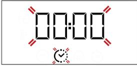
Utilisez  $\pm$  ou  $\bar{\pm}$  pour régler la durée de cuisson et appuyez sur  $\odot$  pour confirmer. Lancez la fonction en tournant le *bouton du thermostat* à la température désirée: un signal sonore et l'écran indiquent la fin de la cuisson.
