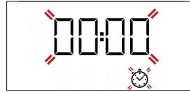
Utilisez  $\pm$  ou  $\bar{\pm}$  pour régler l'heure désirée et appuyez sur  $\odot$  pour confirmer. Un signal sonore se fait entendre lorsque la minuterie a terminé le compte à rebours.
