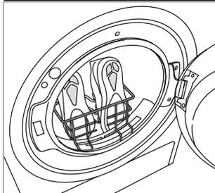
Retire o filtro da porta e coloque o suporte. Os atacadores devem ser enfiados dentro do sapato: a ponta do sapato deve ficar para baixo e as solas para frente. **Não coloque roupa ou outros sapatos no tambor.** Reponha o filtro da porta no fim da secagem.
