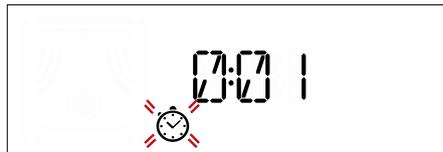
Premere  $\frac{OK}{select}$  per avviare il timer: Un segnale acustico e il display avviseranno del termine del conto alla rovescia.
