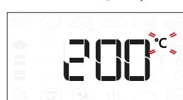
Cuando el ícono °C/°F parpadee en la pantalla, gire el selector para cambiar el valor y después pulse para confirmar y continuar con la modificación de ajustes siguiente (si es posible). También se puede ajustar el nivel del grill (3 = alto, 2 = medio, 1 = bajo) al mismo tiempo.
