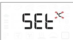
Den Auswahlknopf zur Auswahl der Maßeinheit drehen, anschließend ⌂ zur Bestätigung drücken.
