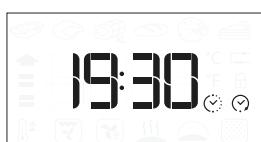
Upozornění: Naprogramování času spuštění odloženého pečení deaktivuje fázi předehřívání trouby. Trouba dosahuje požadované výše teploty postupně, což znamená, že doby přípravy mohou být o něco delší, než je uvedeno v tabulce pro tepelnou úpravu pokrmů.
