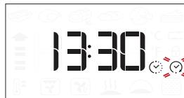
V prípade potreby otáčaním nastavovacieho ovládača nastavte želaný čas ukončenia pečenia, potvrďte stlačením a spustite funkciu.
