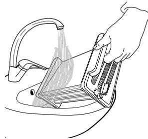
Očistite komoru filtera mašine za sušenje veša vlažnom krpom ili pažljivo usisivačem. Ponovo umetnite donji filter. Okrenite poluge na gore tako da dođu u vertikalni položaj. Zatvorite donji poklopac.
