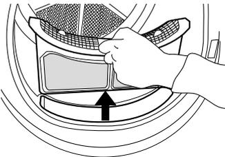
Pritisnite dugme da biste otvorili filter na vratima. Uklonite nakupljene ostatke tkanine. Zatvorite filter i ponovo ga ubacite u pravom smeru, tako da potpuno ulegne u komoru filtera.
