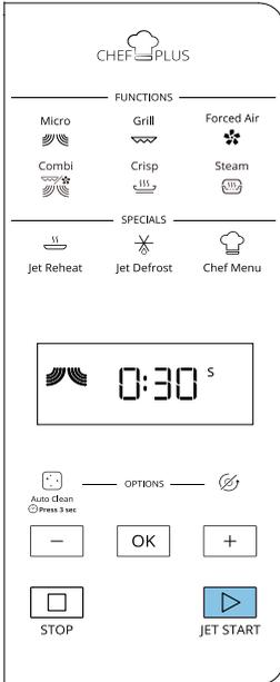
Denne funksjonen starter mikrobølge-funksjonen på maksimal effekt (800 Watt) i 30 sekunder bare ved å trykke på Jet Start-knappen. Denne foreslås for rask oppvarming av matvarer med høyt vanninnhold, for eksempel klare supper, kaffe eller te.
