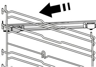
Den oberen Clip des Backauszugs am Seitengitter befestigen und ihn so weit wie möglich entlang gleiten lassen. Den anderen Clip in seine Position absenken.
