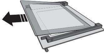
**3.** Reinstale o painel intermédio (marcado com um "R") antes de instalar o painel interior: Para posicionar os painéis de vidro corretamente, certifique-se de que é possível visualizar a marca "R" no canto esquerdo. Insira primeiro a parte mais longa do vidro com a indicação "R" nos suportes e, em seguida, baixe-a até à posição correta. Repita este procedimento para ambos os painéis de vidro.
