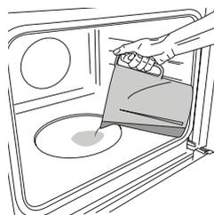
Quando o forno estiver frio, encha a reentrância com a quantidade de água potável sugerida na tabela de cozedura relevante. Configure e ative a função steam
