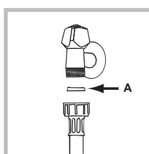
1. Вставте прокладку А у кінець шлангу для подачі води та вкрутіть його у кран з холодною водою з різьбою 3/4 (див. малюнок). Перед підключенням спустіть воду, доки вона не стане прозорою.
