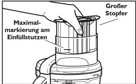
1 Verwenden Sie den Stopfer als Ganzes für den gesamten Einfüllstutzen, um große Zutaten zu verarbeiten.
