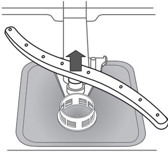
Нижнюю лопасть можно снять, потянув ее вверх.
