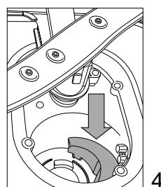
После чистки фильтров установите на место и надежно закрепите фильтрующий узел: это важно для исправной работы посудомоечной машины.
