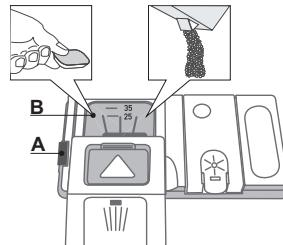
Для открытия дозатора моющего средства используйте фиксатор **A**. Загрузите моющее средство только в сухой дозатор **B**. Моющее средство для предварительной мойки поместите непосредственно в моечную камеру.
