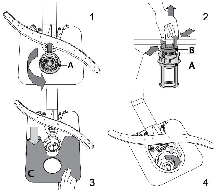
Μετά τον καθαρισμό των φίλτρων, επαναποθετήστε το φίλτρο και στερεώστε το καλά στη θέση του. Αυτό είναι σημαντικό για να διατηρείται η αποτελεσματική λειτουργία του πλυντηρίου πιάτων.
