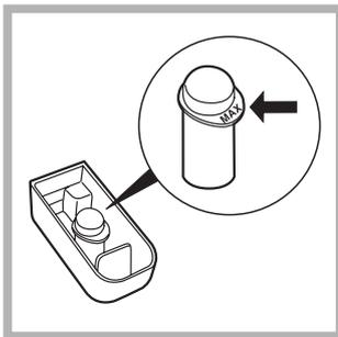
Al verter el blanqueador no debe superar el nivel "máx." indicado en el perno central (véase la figura).
