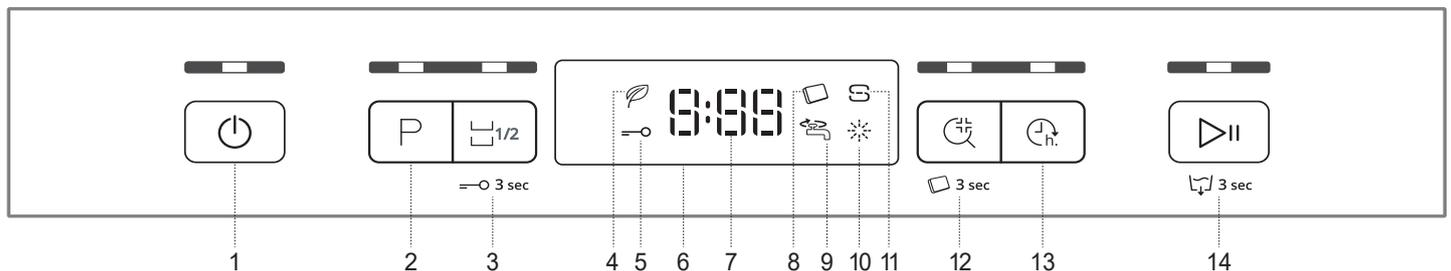
1. Ein-Aus/Reset Taste mit Anzeigelicht
