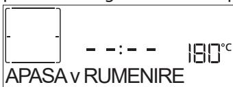
Atunci când pe afişaj apare mesajul aferent, dacă este necesar, apăsați pe  pentru a porni un ciclu de rumenire de cinci minute. Puteți opri funcția oricând apăsând pe butonul  pentru a opri cuptorul.
