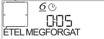
Hangjelzés hallatszik, és a kijelzőn látható a szükséges művelet. Nyissa ki az ajtót, hajtsa végre a kijelzőn látható műveletet, majd csukja be az ajtót és folytassa a sütést. Hasonló módon, a sütési idő 10%-ával a sütés befejezése előtt a sütő figyelmeztet az étel ellenőrzésére.
