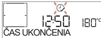
Želaný čas ukončenia prípravy jedla nastavíte stlačením + alebo —, potvrďte ho stlačením ✓ a aktivujte funkciu. Vložte jedlo do rúry a zavorte dverka. Funkcia sa spustí automaticky po uplynutí času vypočítaného tak, aby sa príprava jedla ukončila v čase, ktorý ste nastavili.
