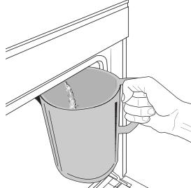
Po vybrání funkce „Vypustit vodu“ stiskněte **[D]** a provedte uváděné kroky: Otevřete dvírka a pod vypouštěcí trysku na spodní straně panelu vložte velkou nádobu. Jakmile se spustí vypouštění, držte nádobu na místě, dokud není proces dokončen. Průměrná doba odtoku vody při plném naplnění je přibližně tři minuty.
