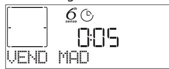
Der høres et lydsignal og på displayet vises handlingen, der skal udføres. Åbn lågen, udfør den handling som display opfordrer
