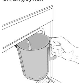
När du väl har valt "Tömning"-funktionen, tryck på och följd de angivna åtgärderna: Öppna luckan och placera en stor kanna under tömningspipen som finns nere till höger på panelen. Så snart som tömningen startat, håll kannan på plats tills tömningen har slutförts. Den genomsnittliga varaktigheten för full tömning är cirka tre minuter.
