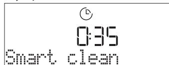
Tryk på ▶ for at aktivere funktionen: Displayet vil opfordre dig til at udføre alle de nødvendige handlinger, for at opnå det bedste rengøringsresultat: Følg anvisningerne og tryk så på ✓, når du er færdig. Tryk på anmodning på ▶ for at aktivere rengøringscyklussen, når alle trinene er fuldført.
