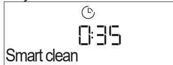
A funkció bekapcsolásához nyomja meg a ▶ gombot: a kijelzőn látható figyelmeztetések jelzik, milyen műveletek szükségesek a legjobb tisztítási eredményhez: Kövesse az utasításokat. Ha kész, nyomja meg a ✓ gombot. Ha az összes lépést végrehajtotta, a megfelelő időben nyomja meg a ▶ gombot a tisztítási program bekapcsolásához.
