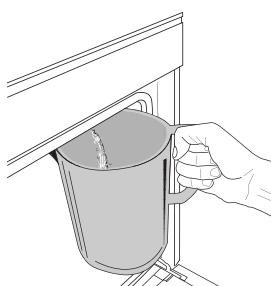
Når funksjonen "Tømming" er valgt, trykk og følg handlingene som indikeres: Åpne døren og plasser en stor mugg under dreneringstuten på nedre høyre side av panelet. Når dreneringen har begynt, holdes muggen på plass til oppgaven er fullført. Dreneringen av full beholder varer i gjennomsnitt i omtrent tre minutter.
