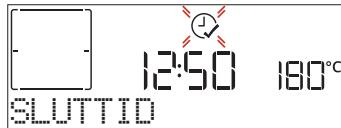
Tryk på + eller — for at indstille tidspunktet, som tilberedningen ønsket afsluttet på, tryk herefter på ✓ for at bekræfte og aktivere funktionen. Sæt retten i ovnen og luk lågen: Funktionen starter automatisk efter den beregnede periode for at tilberedningen slutter på det tidspunkt, du har indstillet.
