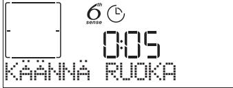
Tällöin kuuluu äänimerkki ja näytöllä näkyy suoritettava toimenpide. Avaa luukku, suorita näytöllä ilmoitettu toimenpide, sulje luukku ja jatka sitten kypsennystä. Samalla tavoin, kun kypsennysajasta on jäljellä 10 %, uuni kehottaa tarkastamaan ruoan.
