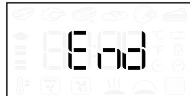
Zum erneuten Starten des Garzyklus ab der Anzeige „End“, ist es möglich durch Drehen von
