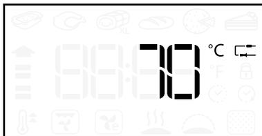
Wenn der Kerntemperaturfühler während der Auswahl einer Funktion eingesteckt wird, wechselt das Display zur Standard-Zieltemperatur des Kerntemperaturfühlers.
