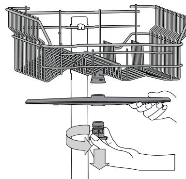
Horní ostřikovací rameno sejměte pootočením plastového upevňovacího kroužku proti směru hodinových ručiček. Horní rameno lze otočit tak, že jeho strana s větším množstvím otvorů směruje vzhůru.
