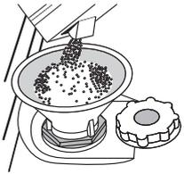
1. Ziehen Sie den Unterkorb heraus und schrauben Sie den Salzbehälterdeckel gegen den Uhrzeigersinn ab.
