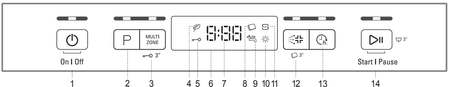
1. Ein-Aus/Reset Taste mit Anzeigelicht
