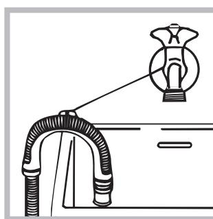
Alternatif olarak, kılavuzu musluğa (şekile bakın) bağlayarak tahliye oturumunu lavabo veya küvetin kenarına yerleştirin (teknik destek merkezinden satın alınabilir). Hortumun serbest kalan ucu
