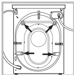
3. Verwijder de 4 schroeven die het apparaat beschermen tijdens het vervoer en de rubberen ring met bijbehorende afstandsleider die zich aan de achterkant bevinden (zie afbeelding).
