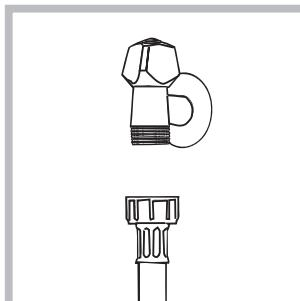
1. Schrauben Sie den Wasserschlauch an einen Kaltwasserhahn mit  $\frac{3}{4}$ -Zoll-Gewindeanschluss an (siehe Abbildung). Lassen Sie das Wasser vor dem Anschluss so lange auslaufen, bis klares Wasser austritt.
