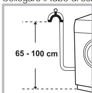
In alternativa, appoggiare il tubo di scarico al bordo di un lavandino o di una vasca, legando la guida (acquistabile presso il servizio assistenza) al rubinetto (vedi figura). L'estremità libera del tubo di scarico non deve rimanere immersa nell'acqua.
