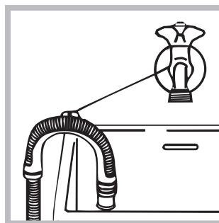
Autrement, accrocher le tuyau de vidange à un évier ou à une baignoire, dans ce cas, attacher la crosse (à acheter au service d'assistance) au robinet (voir figure). L'extrémité libre du tuyau d'évacuation
