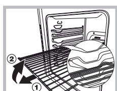
ATENÇÃO! O forno está equipado com um sistema de bloqueio das grelhas que permite retirá-las sem que estas ressaiam do forno(1).
