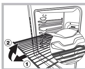
**FIGYELEM!** A sütő rác-srögzítő rendszerrel van ellátva, mely megakadályozza, hogy a rácsok a kihúzással kiessének a sütőből (1).
