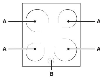
Varná doska je vybavená elektrickými vykurovacími telesami. Pri ich používaní, nasledujúce položky na varnej doske súčrvenejú. A. Varná zóna so sálavými vykurovacími telesami.
