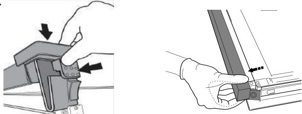
**2.** Zvedněte a pevně držte vnitřní sklo oběma rukama, přeneste sklo na měkký povrch. Poté začněte s čištěním.
