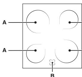
Varná deska je vybavena elektrickými sálavými topnými tělesy. Jsou-li v provozu, následující prvky zčervenají:
