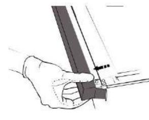
**2.** Levante e segure firmemente o vidro interior com ambas as mãos, removendo-o e colocando-o sobre uma superfície suave antes de proceder à sua limpeza.
