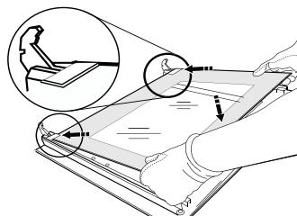
**4.** Szerelje vissza a felső élet: a megfelelő helyzetet kattanás jelzi. Az ajtó visszaszerelése előtt ellenőrizze, hogy a tömítés a helyén van-e.
