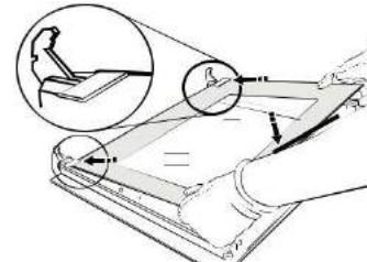
**4.** Instale novamente a extremidade superior: irá ouvir um clique, indicando que está bem posicionado. Certifique-se de que a vedação está segura antes de montar novamente a porta.
