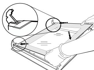
**4.** Namontujte horní lištu: zacvaknutí indikuje správnou montáž. Před nasazením dvířek zkонтrolujte těsnění.
