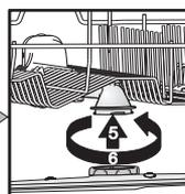
Insérez et serrez à fond les bras d'aspersion supérieur et inférieur.
