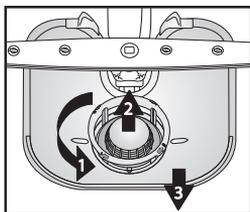
Dévissez le microfiltre (1), retirez-le (2) et retirez le filtre à tamis fin (3).
