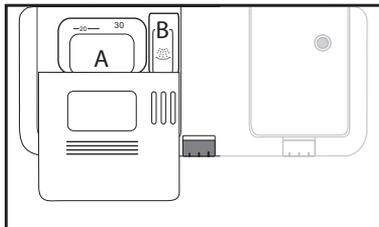
Le distributeur comprend deux compartiments. Le compartiment **A** contient le détergent utilisé pour le lavage principal. Le compartiment **B** permet l'ajout d'une dose supplémentaire de détergent.
