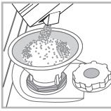
2. Nur bei erstmaliger Inbetriebnahme: Füllen Sie den Behälter bis zum Rand mit Wasser.
