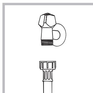
1. Conectați furtunul de alimentare, înșurubându-l la un robinet de apă rece cu gura filetată de l'gaz (a se vedea figura). Înainte de conectare, lăsați apa să curgă până când nu a devenit împedite.
