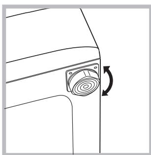
2. Dacă podeaua nu este perfect orizontală, compensați neregularitățile deșurubând sau înșurubând piciorușele anterioare (a se vedea figura); unghiul de înclinare, măsurat pe planul de lucru, nu trebuie să depășească 2°.
