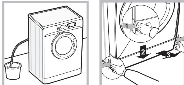
2. Zkontrolujte, zda je hladina vody uvnitř zařízení nižší, než je úroveň otevření dvířek; v opačném případě vypusťte přebytečnou vodu vypouštěcí hadicí a zachytěte ji do vědra, jak je znázorněno na obrázku.
