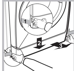
2. проверите да ли је ниво воде унутар машине испод нивоа отвора; у супротном извуките вишак воде кроз испусно црево сакупљајући је у кофу као што је показано на слици.
