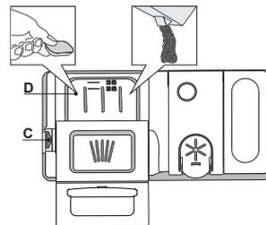
1. Per il dosaggio corretto del detersivo fare riferimento ai dati sopra riportati. La vaschetta **D** contiene indicatori di livello per facilitare il dosaggio del detersivo.
